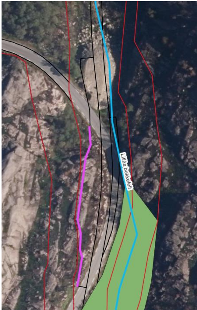
Figur 2.4. Nord for den sørligste fjellskjæringen ligger det en stor steinfylling hvor mye av overvannet fra sprengningsarbeidene trolig vil infiltreres, før det eventuelt når bekken som renner igjennom anleggsområdet.
